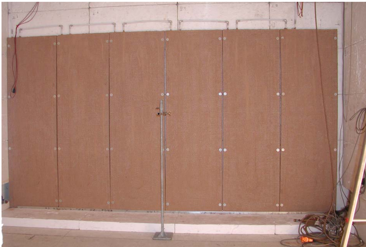
Abb. 1: Prüfaufbau WEM® Klimatelemente beim HLK in Stuttgart
